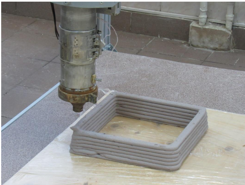
Рисунок 1. Печать конструкций на строительном 3D-принтере.
