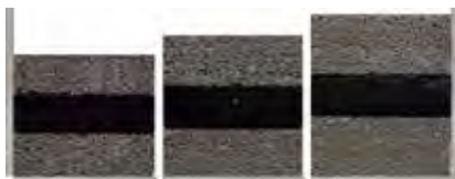
Экспериментальные образцы многослойных теплоизоляционно-декоративных стеклокомпозиционных материалов без декоративного покрытия
