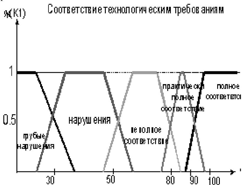
Рис. 1. Функция принадлежности лингвистической переменной «Соответствие технологическим требованиям»
