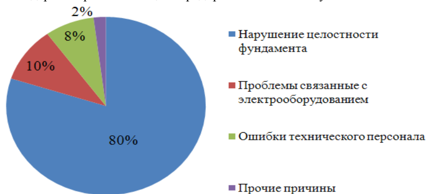
Рис. 2 Удельный вес основных причин отказов на ленточных пилорамах по экспертным оценкам специалистов деревообрабатывающего предприятия ООО «Самусь»
