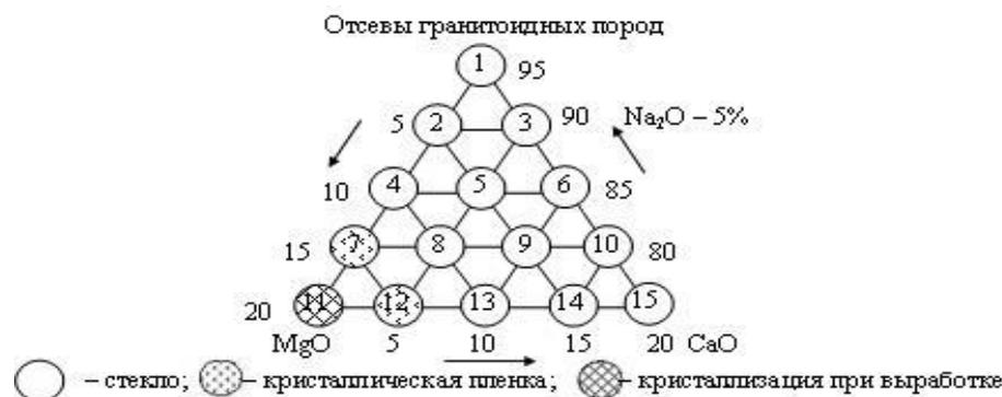
**Рис. Область составов экспериментальных стекол на основе отсевов гранитоидных пород и результаты синтеза стекол**
