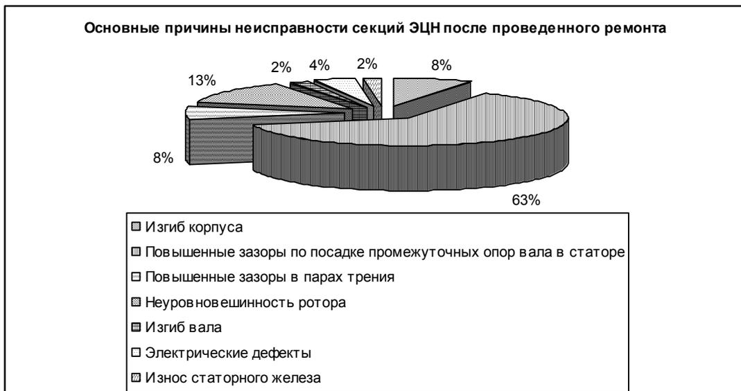
Рис. 3. Диаграмма основных причин неисправности секций ПЭД после проведенного ремонта
