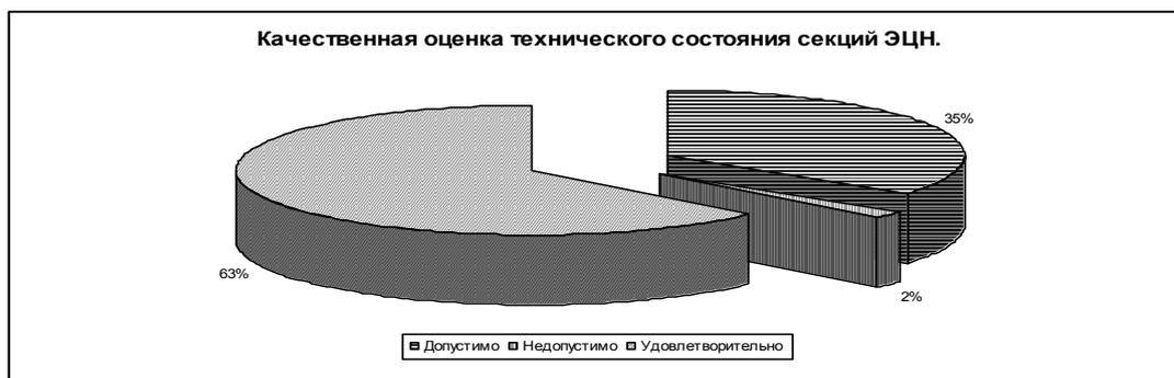
*Рис. 2. Диаграмма качественной оценки технического состояния секций ЭЦН*
