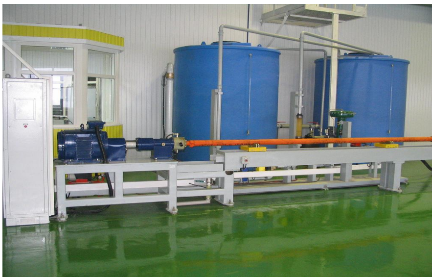
Рис. Стенд обкатки и проведения контрольных испытаний ЭЦН
