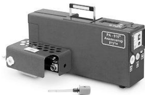
Рис. 1. Ртутный анализатор РА-915+ с пиролитической приставкой РП-91С
