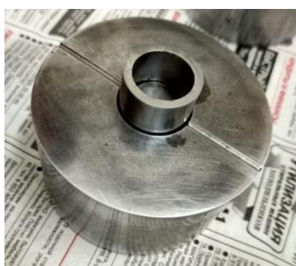
Рис. 1. Пресс-форма для компактирования образцов тороидальной формы
