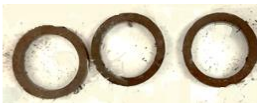
Рис. 2. Образцы ферритовой керамики, полученные при различных давлениях прессования
