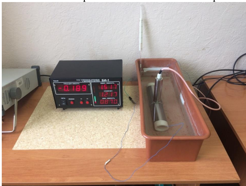
Рис. 1. Схема измерения емкости провода с помощью САР-10.1
