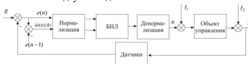
Рис. 1. Функциональная структура системы управления с нечетким регулятором: g – входной сигнал, f_1 – внешний сигнал шумовых помех, f_2 – помехи сигнала управления, u – сигнал управления, y – выходной сигнал. Для обеспечения стабилизации выходного сигнала блоком нечеткой логики (БНЛ) используются две входных переменных – ошибка e(n) и скорость изменения ошибки de(n)/dt
