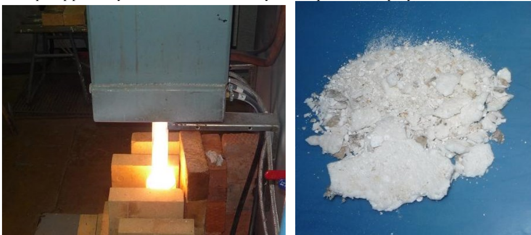
Рис. 1. Плазменный стенд «Высокочастотный факельный плазмотрон на базе генератора ВЧГ8-60/13» для исследования процесса плазменной иммобилизации ИЛО
