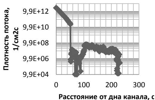
Рисунок 1. Распределение плотности потока тепловых нейтронов по длине канала ГЭК-6 с установленным кадмиевым стаканом на удалении от а.з. на расстоянии 53 см
