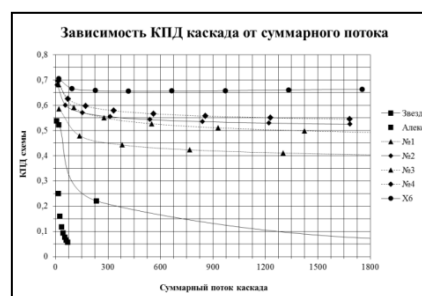
Рис. 2. График зависимости КПД каскада от суммарного потока вещества в каскаде для различных схем соединения
