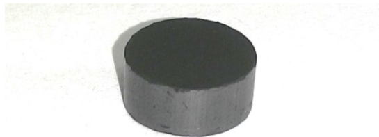
Рис. 1. Углеродная таблетка, изготовленная при давлении прессования 60 МПа, время выдержки – 10 минут
