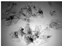
**Рис. 1.** Вид частиц ОКФ, синтезированных осадением из растворов  $\text{pH}=6,5$   $\tau=72$  ч, ув.  $\times 120$
