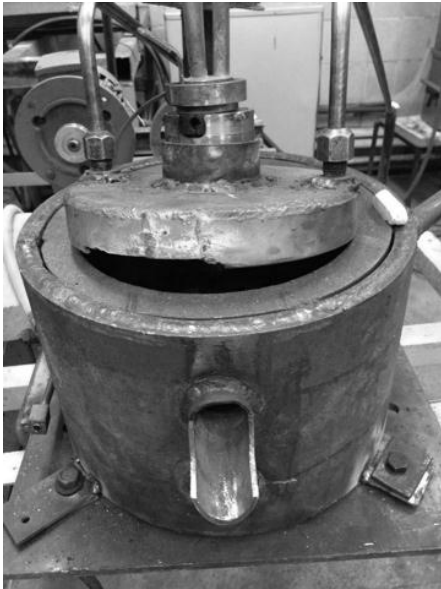
Рис. 1. Схема экспериментальной установки с комбинированным источником тепла для утилизации золошлаковых отходов, при получении минерального волокна: 1 – плазмотрон; 2 – сливной желоб; 3 – водоохлаждаемая плавильная печь; 4 – графитовый тигель; 5 – устройство волоконнообразования; 6 – шнековый питатель; 7 – дозирующее устройство; 8 – электродвигатель; 9 – плазменная дуга; 10 – расплав; 11 – минеральные волокна.
