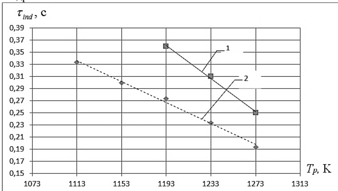
Рис. 2. Экспериментальные зависимости времени задержки зажигания травяной ветоши от начальной температуры частицы: 1 – h_p = 1,3 \cdot 10^{-2} м, d_p = 0,6 \cdot 10^{-2} м; 2 – h_p = 1,7 \cdot 10^{-2} м, d_p = 0,8 \cdot 10^{-2} м
