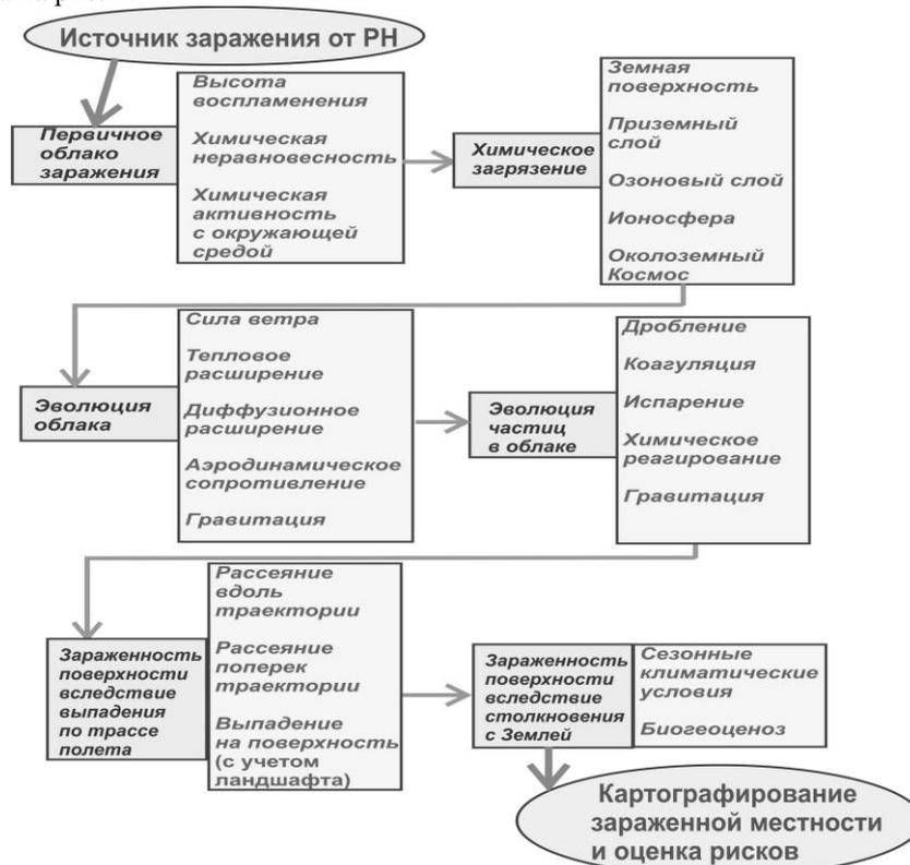
Рис. 1. Схема методологии прогнозирования последствий падения отработанных ступеней ракет-носителей.
