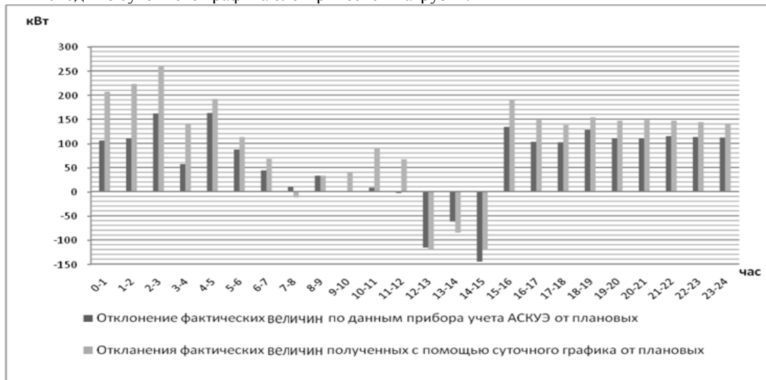
Рис. 1 Отклонения договорных объемов потребления, разработанных непосредственно Абонентом, от фактических, сформированных на основании данных приборов учета и без них.
