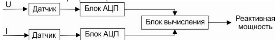
Рис. 1. Блок-схема, отображающая процесс измерения реактивной энергии путём аналого-цифрового преобразования величин напряжения и тока и последующей реализации математических формул реактивной мощности и энергии.
