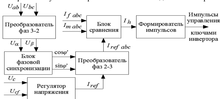
Рис.1. Функциональная схема системы управления активной системой коррекции формы кривых тока и напряжения с использованием фазовых преобразований для компенсации высших гармоник тока и напряжения
