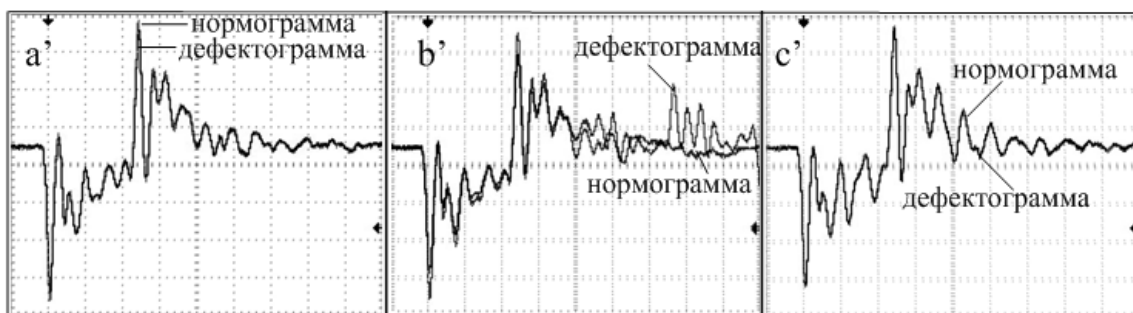
Рис. 4. Совмещенные нормограммы с дефектограммами трансформатора (рис. 1, б), у которого закорочены витки обмотки высокого напряжения фазы В: а – отклик на обмотке aa' , б – отклик на обмотке bb' , в – отклик на обмотке cc'
