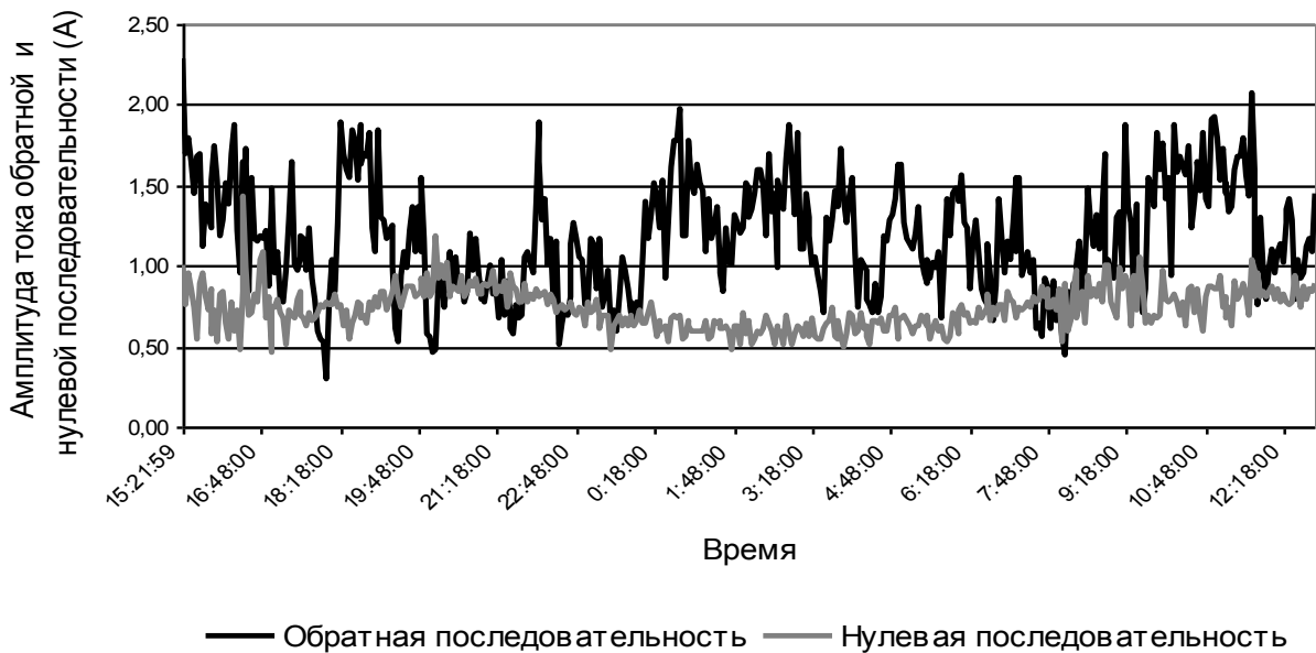
Рис. 13. Изменения токов обратной и нулевой последовательностей линии 110 кВ
