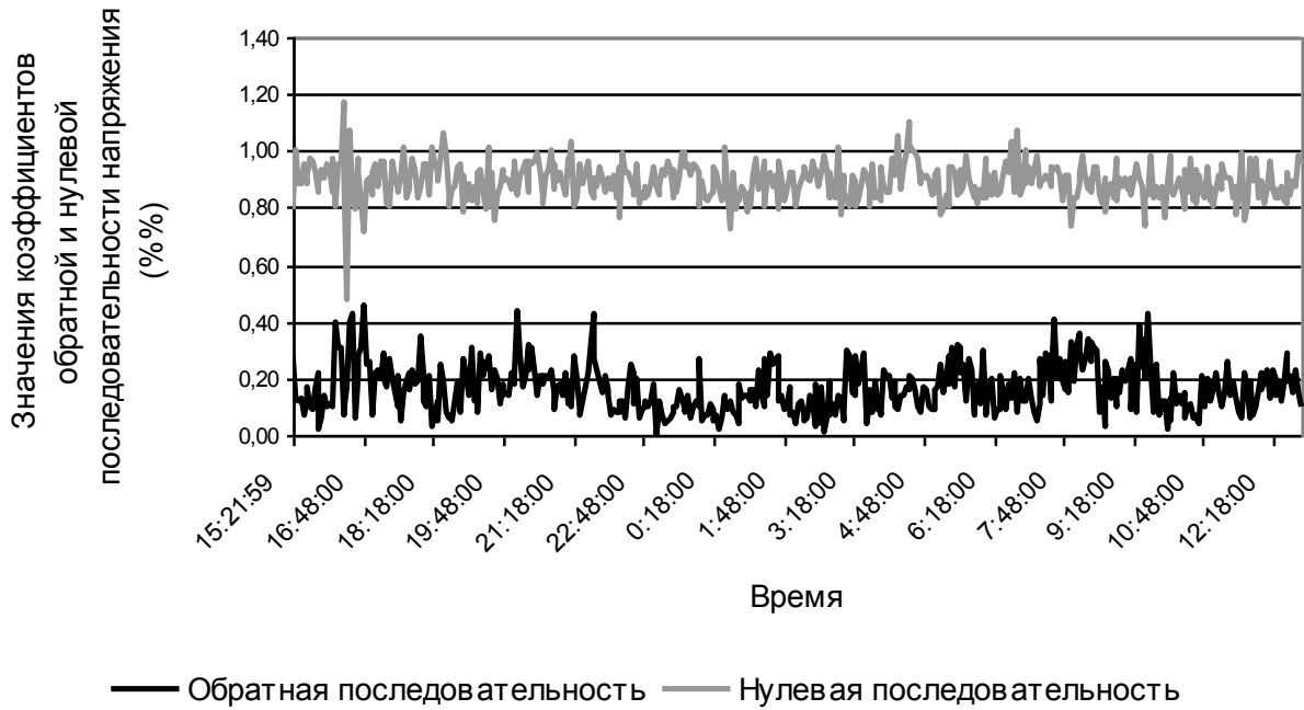
Рис. 14. Изменения коэффициентов обратной (нижняя диаграмма) и нулевой (верхняя диаграмма) последовательностей напряжений
