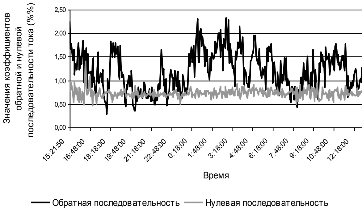
Рис. 15. Изменения коэффициентов обратной и нулевой последовательностей токов
