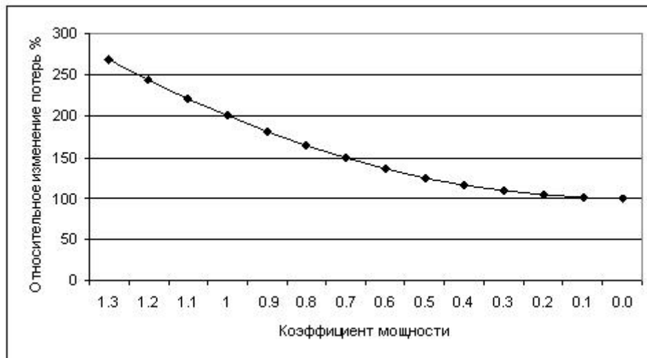
Рис. 1. Относительное изменение потерь активной мощности, обусловленное передачей реактивной мощности
