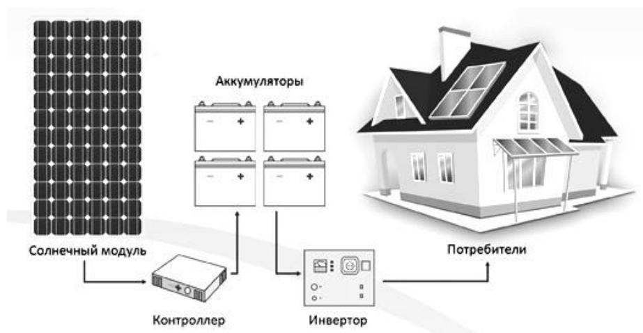
Рис. 1. Схема автономной системы электроснабжения на базе солнечных батарей
