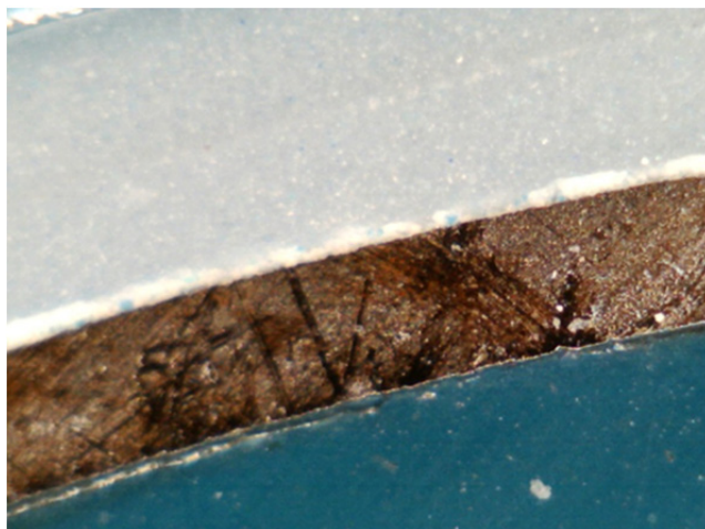
Рис. 1. Покрытие системой «Triceram» коронки из никелида титана, оптическая микроскопия, \times 320
