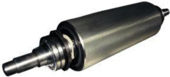
Вальцы на мельницу диаметром 250 мм. Вальцы изготавливаются из двухслойного чугуна: внутренний слой - серый чугун, внешний - отбеленный чугун, что позволяет производить реставрацию рабочей поверхности вальцов 5-7 раз. Толщина рабочего отбеленного слоя - 20 мм. Твердость по Роквеллу - 47,4-54,7 единиц.
