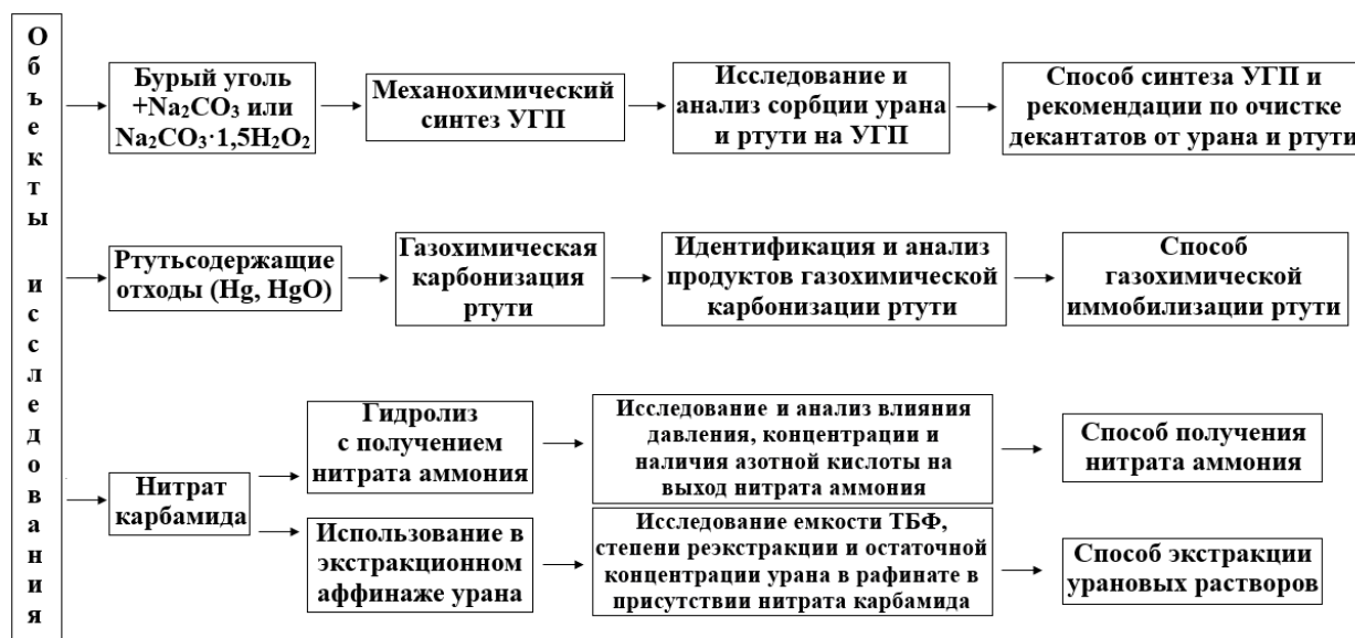
Рисунок 2.5 – Структурно-методологическая схема разработки способов переработки уран- и ртутьсодержащих отходов
