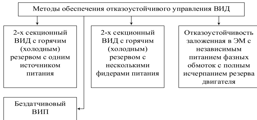
Рисунок 5.1. Методы обеспечения отказоустойчивого управления ВИП
