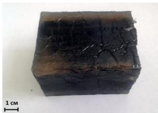
Рисунок 4.2 – Изготовленный образец для измерения диэлектрических свойств брусок, залитый в полиэфирную смолу
