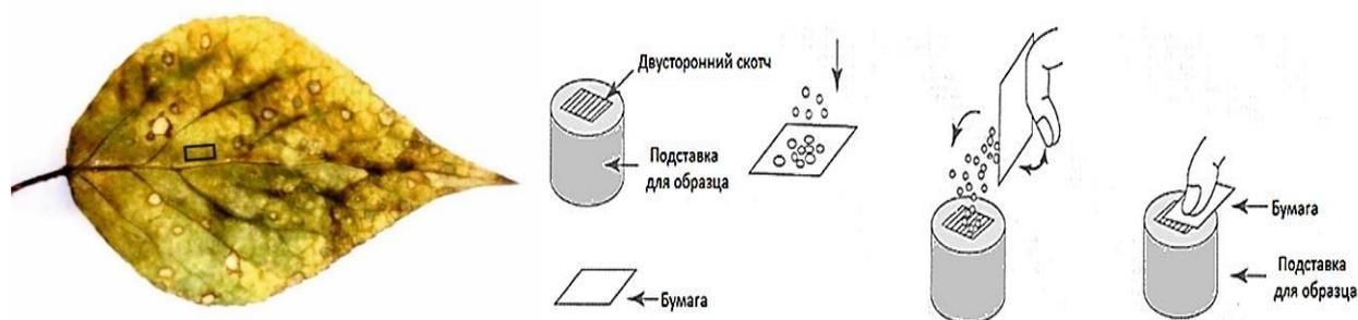
Рисунок 12 – Схема подготовки растительного материала для анализа методом СЭМ: место отбора фрагмента (слева); подготовка материала для СЭМ (справа)
