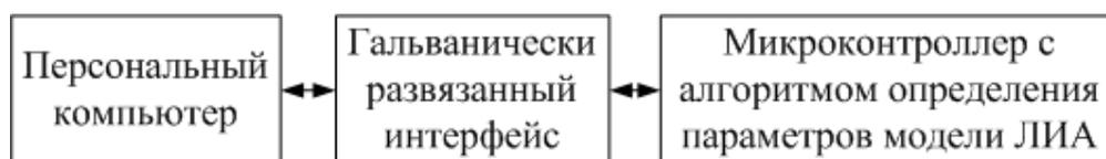
Рисунок 3.6 – Структурная схема экспериментальной установки для реализации алгоритма определения параметров модели ЛИА
