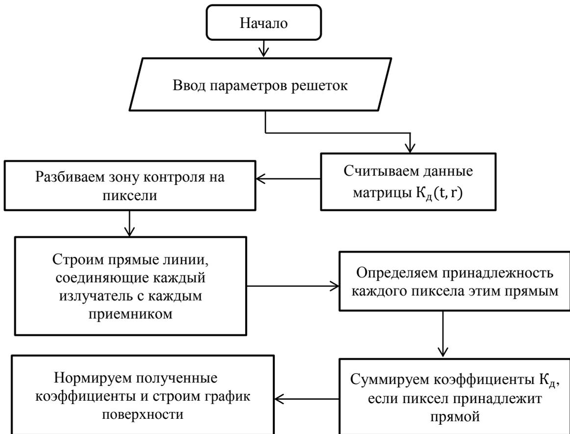
Рисунок 2.10 – Алгоритм реконструкции зоны контроля
