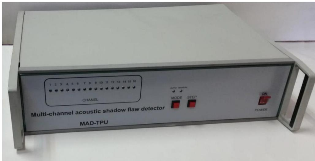
Рисунок 3.7 – Фотография ультразвукового дефектоскопа
