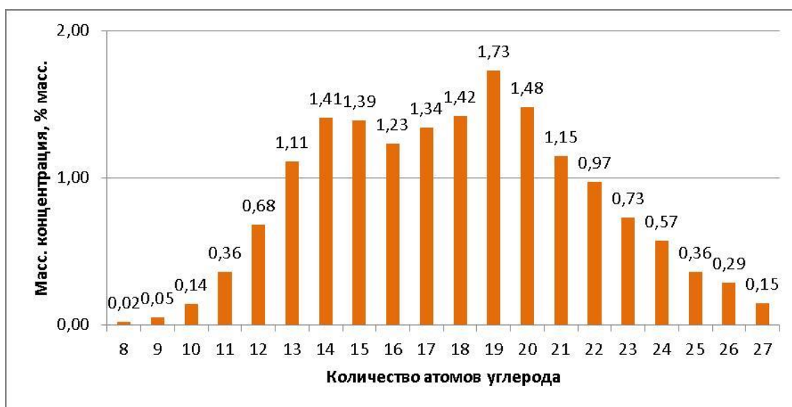
Рисунок 21 – Массовая концентрация парафиновых углеводородов нормального строения в зависимости от числа атомов углерода
