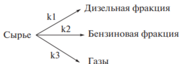
Рисунок 10 – Формализованная схема превращений компонентов в процессе гидрокрекинга
