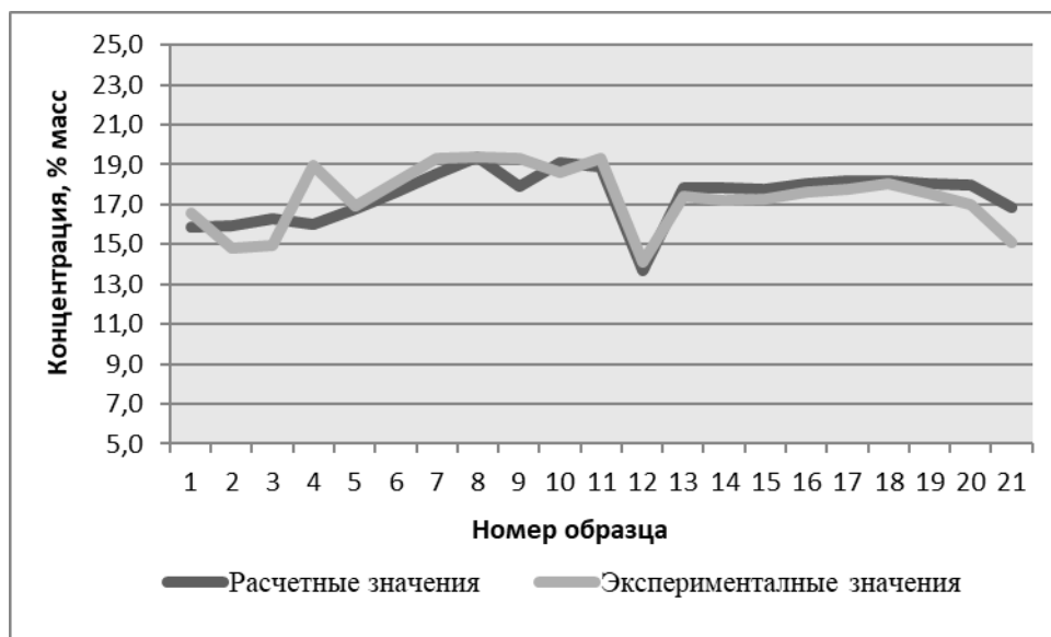
Рисунок 22 – Экспериментальные и расчетные массовые концентрации нормальных парафинов в сырье
