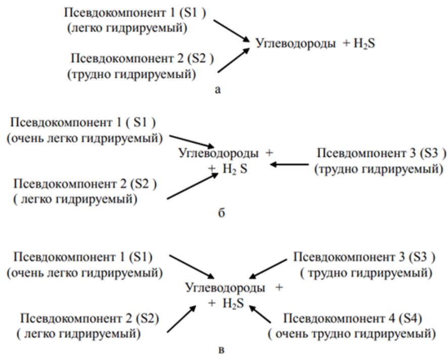
Рисунок 9 – Варианты схем формализованного химизма в процессе гидрообессеривания дизельного топлива
