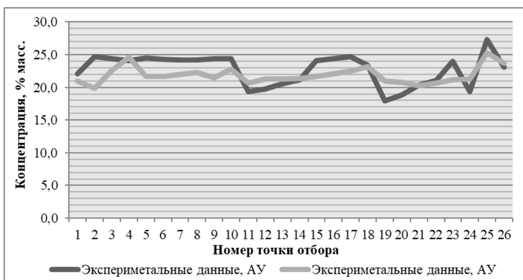
Рисунок 25 – Массовые концентрации ароматических углеводородов в продукте
