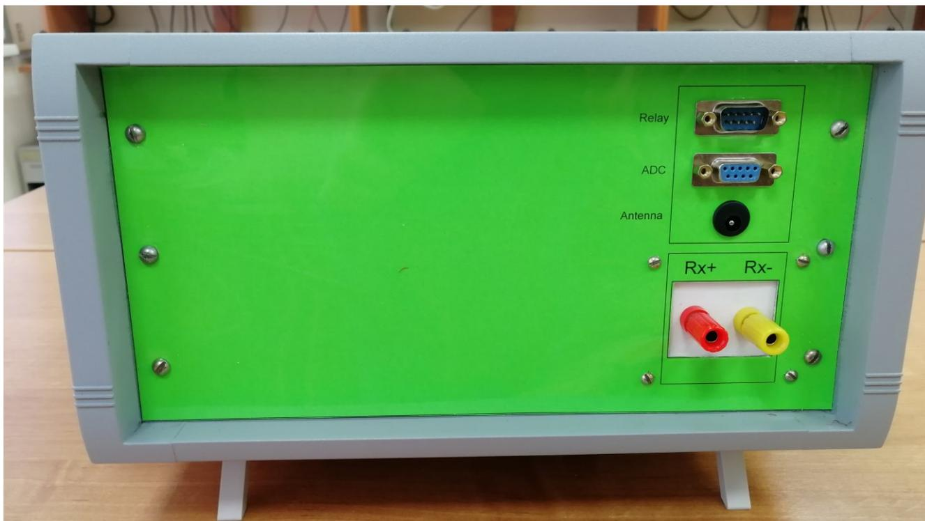
Relay – разъем управления реле; ADC – разъем с аналоговыми выходными сигналами измеряемого сопротивления; Antenna – разъем для подключения антенны; Rx+ – положительная клемма; Rx- – отрицательная клемма
