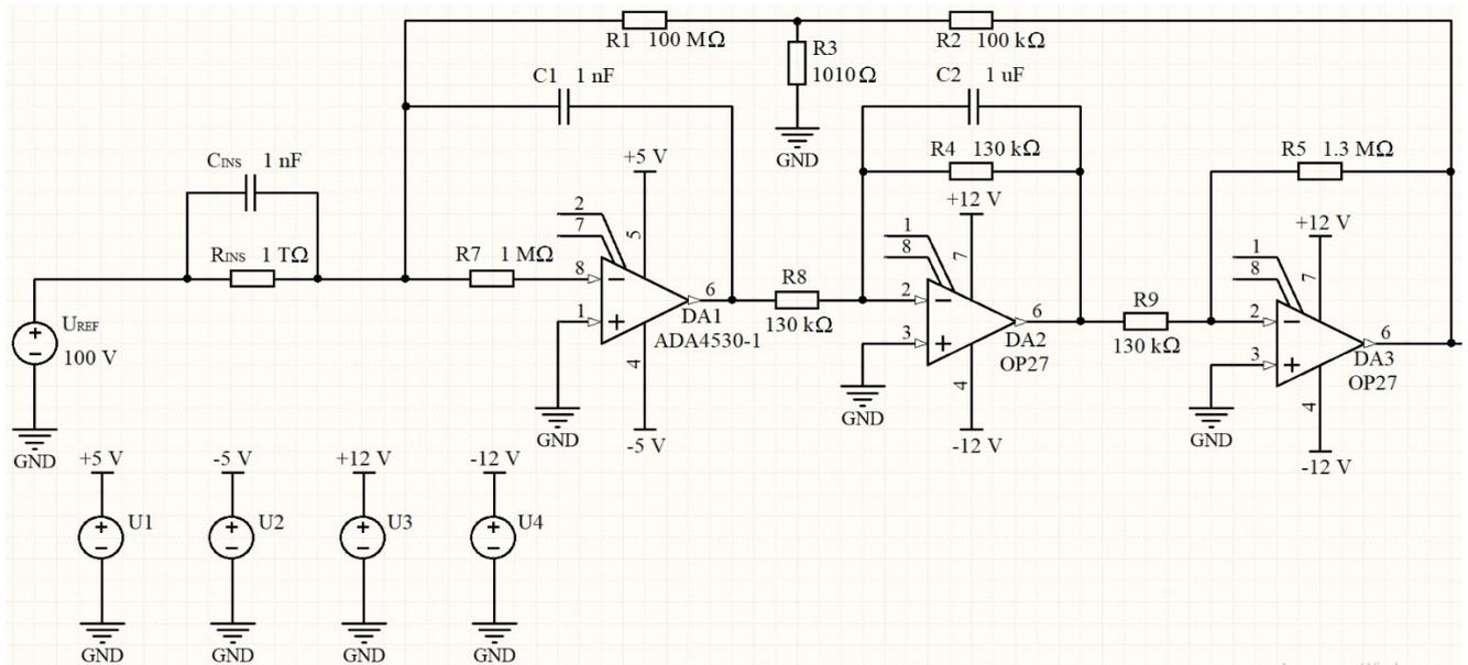
Рисунок 2.7 – Электрическая схема исследуемого тераомметра в программе симуляции Altium Designer
