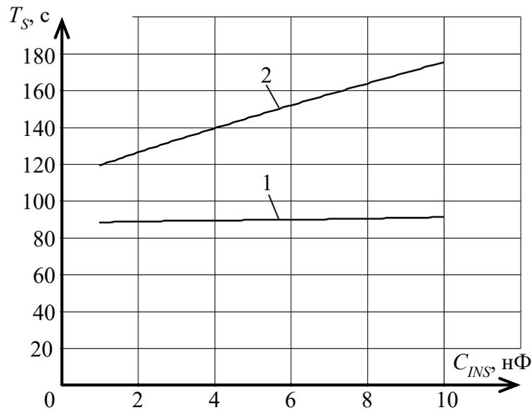
1 – теоретическая зависимость ПСН с Т-образной обратной связью ( $R_I=100$  МОм,  $R_2=100$  кОм,  $R_3=1010$  Ом,  $R_{EQ}=10$  ГОм); 2 – теоретическая зависимость ПСН с классической обратной связью  $R_{EQ}=10$  ГОм
