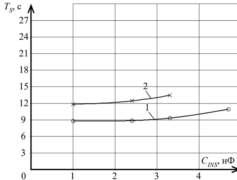
1 – экспериментальная зависимость ПСН с Т-образной обратной связью ( $R1=100$  МОм,  $R2=100$  кОм,  $R3=1010$  Ом,  $R_{EQ}=10$  ГОм); 2 – экспериментальная зависимость ПСН с классической обратной связью  $R_{EQ}=10$  ГОм
