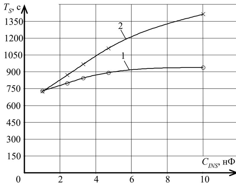
1 – экспериментальная зависимость ПСН с Т-образной обратной связью ( $R1=100$  МОм,  $R2=100$  кОм,  $R3=1010$  Ом,  $R_{EQ}=10$  ГОм); 2 – экспериментальная зависимость ПСН с классической обратной связью  $R_{EQ}=10$  ГОм
