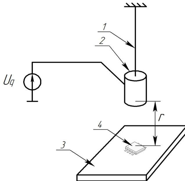
1 – нить из изоляционного материала; 2 – металлический груз (электрод); 3 – печатная плата ПСН; 4 – входной операционный усилитель ПСН;  $U_q$  – источник постоянного напряжения
