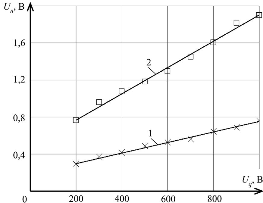
1 – воздействие заряженного электрода на ПСН; 2 – воздействие заряженного электрода на контролируемый кабель
