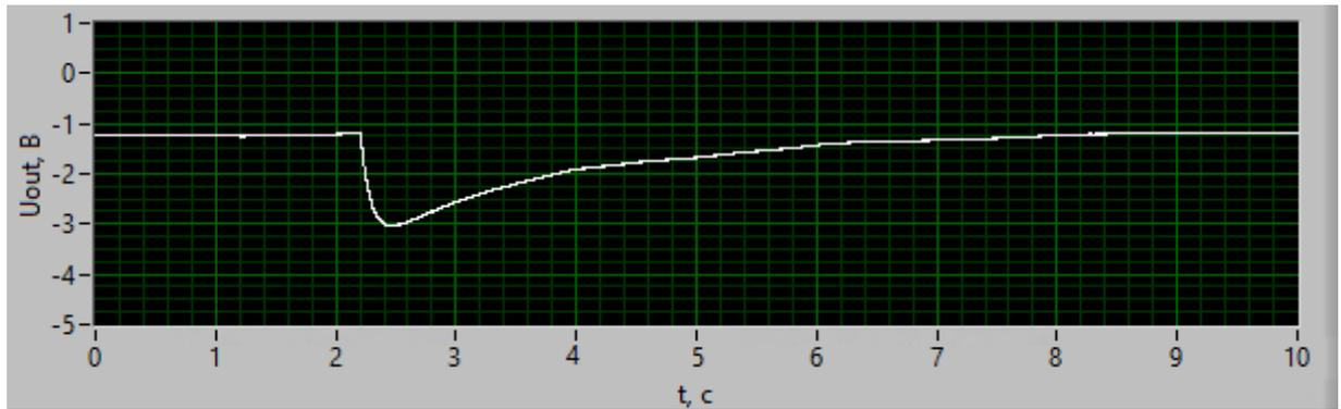
Рисунок 3.5 – Сигнал низкочастотной помехи на выходе ПСН, вызванный кратковременным воздействием на электрод постоянным напряжением ( $R_{INS}=1000$  ГОм,  $CI=1$  нФ,  $U_{REF}=100$  В,  $R1=100$  МОм,  $R2=100$  кОм,  $R3=1010$  Ом,  $R_{EQ}=10$  ГОм,  $U_q=1000$  В,  $r=40$  мм)
