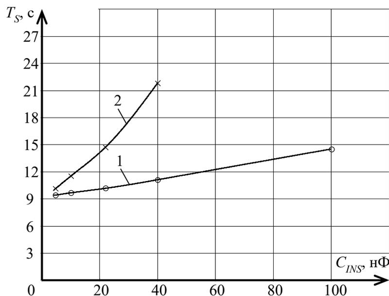
1 – экспериментальная зависимость ПСН с Т-образной обратной связью ( $R1=10$  МОм,  $R2=100$  кОм,  $R3=1010$  Ом,  $R_{EQ}=1$  ГОм); 2 – экспериментальная зависимость ПСН с классической обратной связью  $R_{EQ}=1$  ГОм
