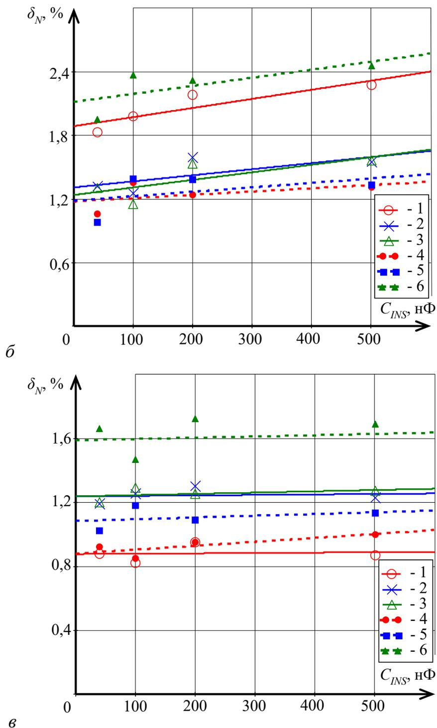
1 – двухканальная схема ПСН без антенны с АОСММО; 2 – двухканальная схема ПСН без антенны с АОСЛА; 3 – одноканальная схема ПСН без антенны с применением ФНЧ; 4 – двухканальная схема ПСН с антенной с АОСММО; 5 – двухканальная схема ПСН с антенной с АОСЛА; 6 – одноканальная схема ПСН с антенной с применением ФНЧ
