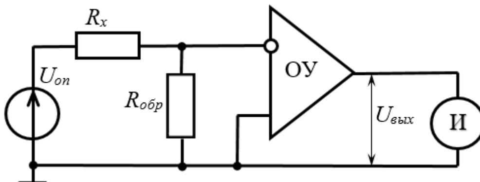
Рисунок 1.5 – Схема измерения сопротивления по методу стабилизированного тока
