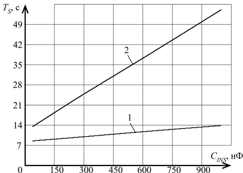
1 – теоретическая зависимость ПСН с Т-образной обратной связью ( $R1=1$  МОм,  $R2=100$  кОм,  $R3=1010$  Ом,  $R_{EQ}=0,1$  ГОм); 2 – теоретическая зависимость ПСН с классической обратной связью  $R_{EQ}=0,1$  ГОм
