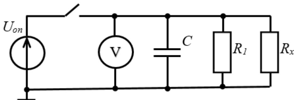
Рисунок 1.11 – Схема измерения сопротивления методом заряда-разряда конденсатора
