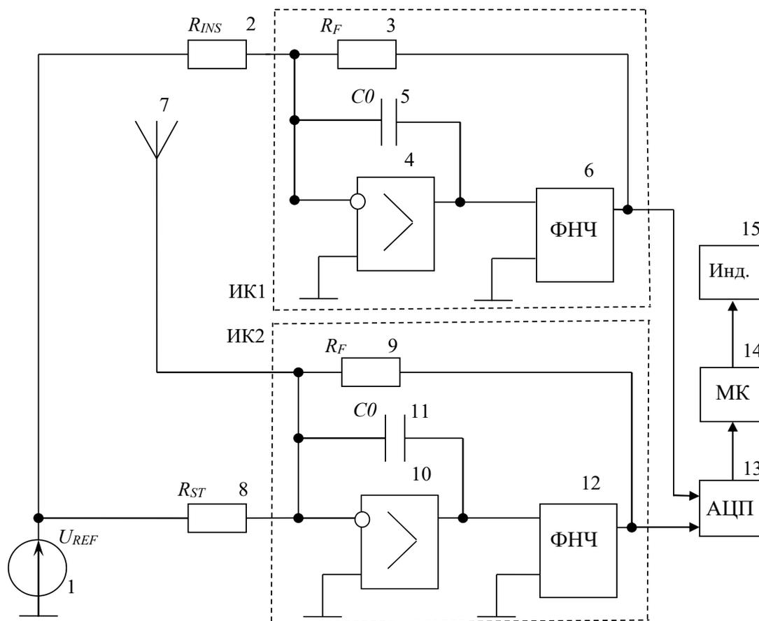
ИК1 – первый измерительный канал; ИК2 – второй измерительный канал; 1 – источник опорного напряжения (ИОН); 2 – сопротивление изоляции кабеля; 3, 9 – образцовое сопротивление обратной связи; 4, 10 – ОУ; 5, 11 – конденсатор; 6, 12 – фильтр низких частот (ФНЧ); 7 – антенна; 8 – эталонный резистор; 13 – аналого-цифровой преобразователь (АЦП); 14 – микроконтроллер; 15 – индикатор
