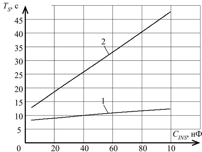
1 – теоретическая зависимость ПСН с Т-образной обратной связью ( $R_I=10$  МОм,  $R_2=100$  кОм,  $R_3=1010$  Ом,  $R_{EQ}=1$  ГОм); 2 – теоретическая зависимость ПСН с классической обратной связью  $R_{EQ}=1$  ГОм
