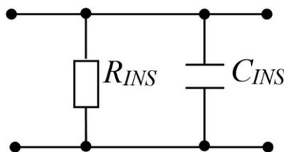
Рисунок 1.3 – Упрощенная схема замещения реального двухжильного кабеля на низкой частоте
