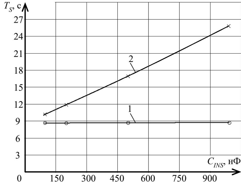
1 – экспериментальная зависимость ПСН с Т-образной обратной связью ( $R1=1$  МОм,  $R2=100$  кОм,  $R3=1010$  Ом,  $R_{EQ}=0,1$  ГОм); 2 – экспериментальная зависимость ПСН с классической обратной связью  $R_{EQ}=0,1$  ГОм
