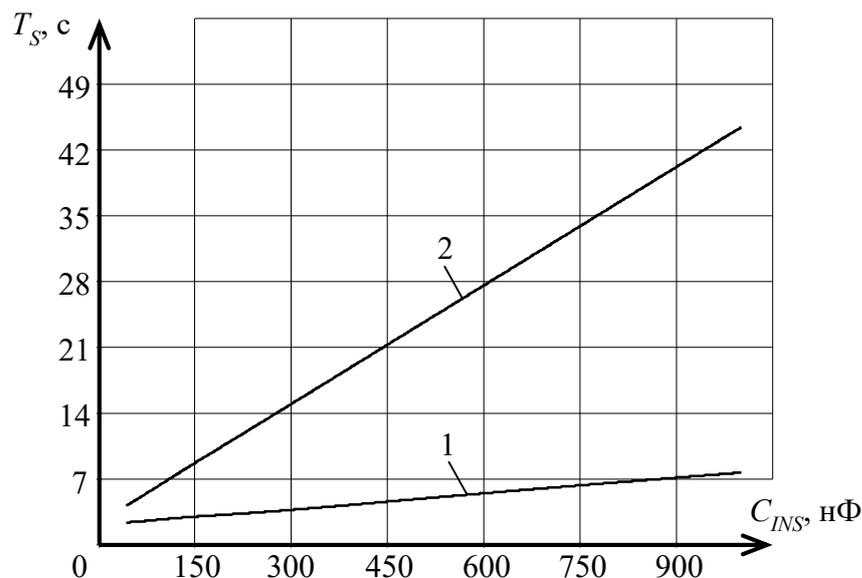
1 – теоретическая зависимость ПСН с Т-образной обратной связью ( $R1=1$  МОм,  $R2=100$  кОм,  $R3=1010$  Ом,  $R_{EQ}=0,1$  ГОм); 2 – теоретическая зависимость ПСН с классической обратной связью  $R_{EQ}=0,1$  ГОм
