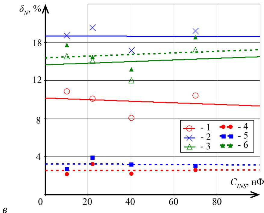
1 – двухканальная схема ПСН без антенны с АОСММО; 2 – двухканальная схема ПСН без антенны с АОСЛА; 3 – одноканальная схема ПСН без антенны с применением ФНЧ; 4 – двухканальная схема ПСН с антенной с АОСММО; 5 – двухканальная схема ПСН с антенной с АОСЛА; 6 – одноканальная схема ПСН с антенной с применением ФНЧ
