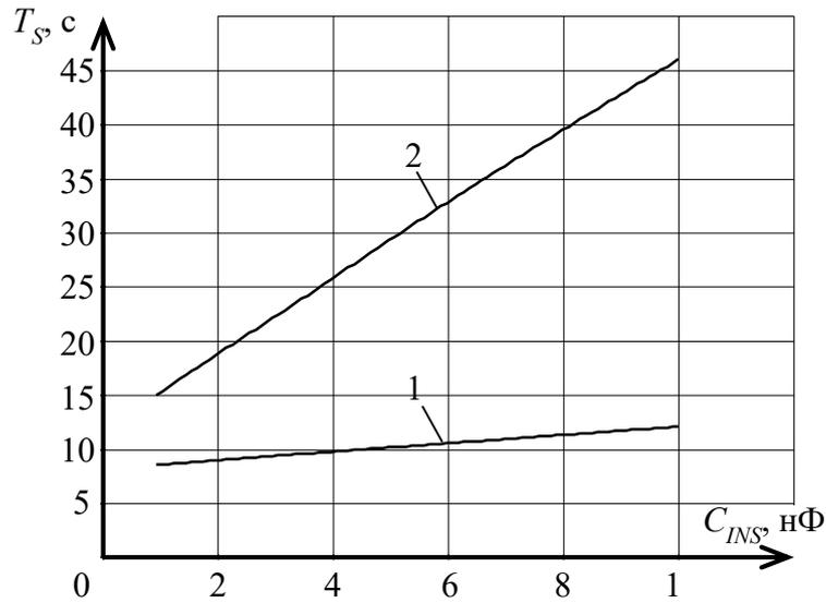
1 – теоретическая зависимость ПСН с Т-образной обратной связью ( $R1=100$  МОм,  $R2=100$  кОм,  $R3=1010$  Ом,  $R_{EQ}=10$  ГОм); 2 – теоретическая зависимость ПСН с классической обратной связью  $R_{EQ}=10$  ГОм
