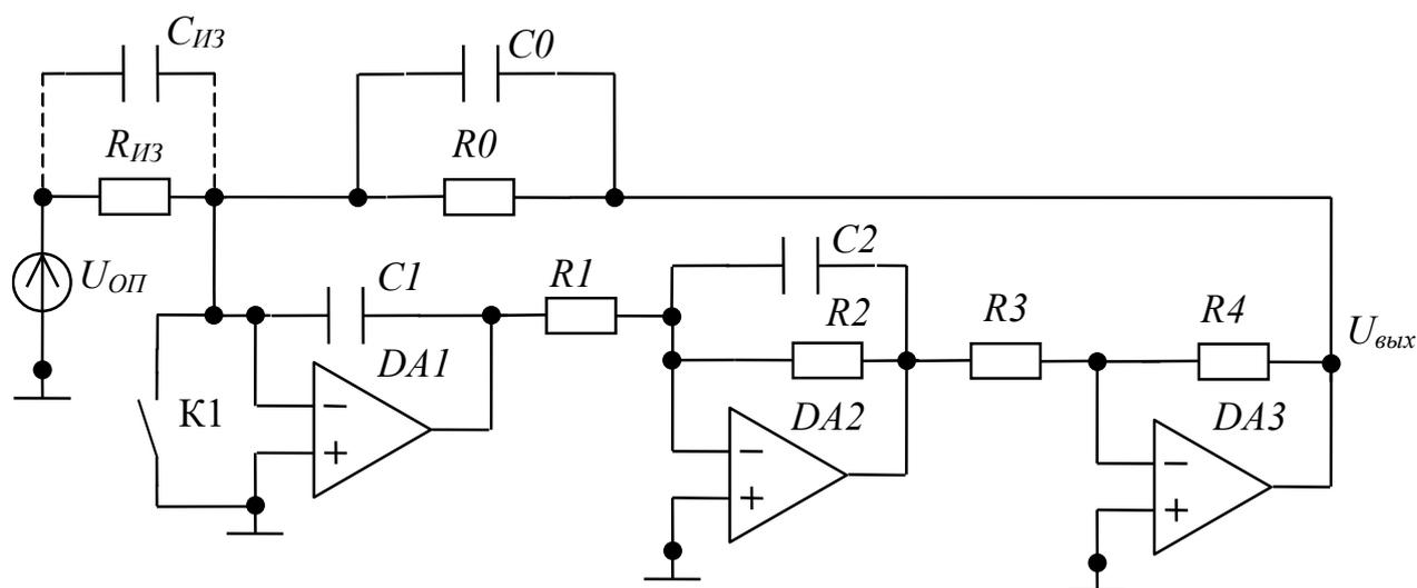
Рисунок 1.12 – Схема измерения сопротивления на основе преобразователя сопротивлений с интегратором в первом каскаде
