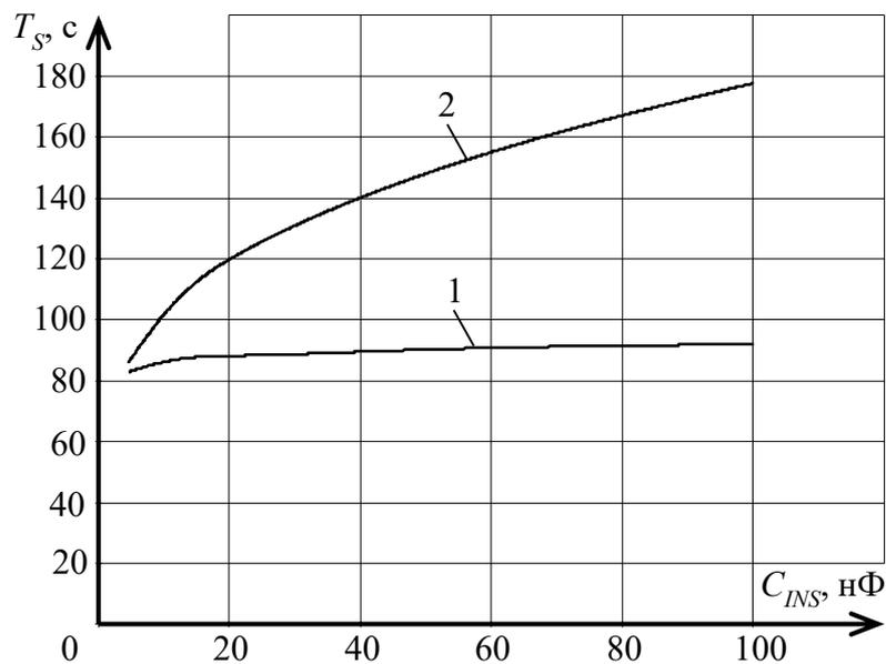
1 – теоретическая зависимость ПСН с Т-образной обратной связью ( $R1=10$  МОм,  $R2=100$  кОм,  $R3=1010$  Ом,  $R_{EQ}=1$  ГОм); 2 – теоретическая зависимость ПСН с классической обратной связью  $R_{EQ}=1$  ГОм
