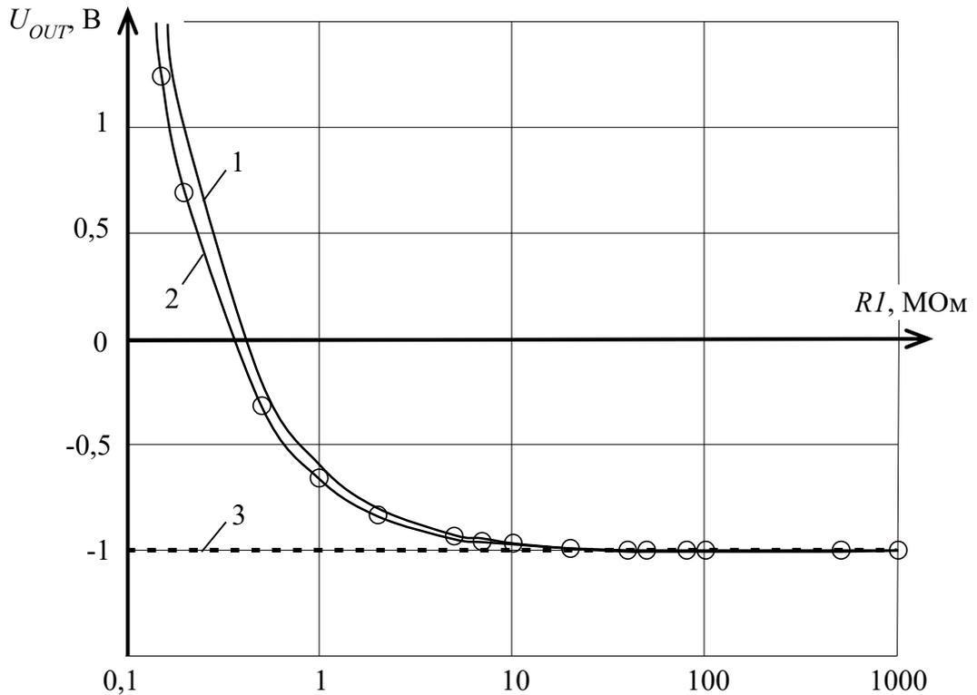
1 – теоретическая зависимость  $U_{OUT(T)}$  с входным ОУ ADA4530-1; 2 – экспериментальная зависимость  $U_{OUT(EXP)}$  с входным ОУ ADA4530-1; 3 – теоретическая зависимость, при идеальном ОУ  $U_{OUT(ID)}$
