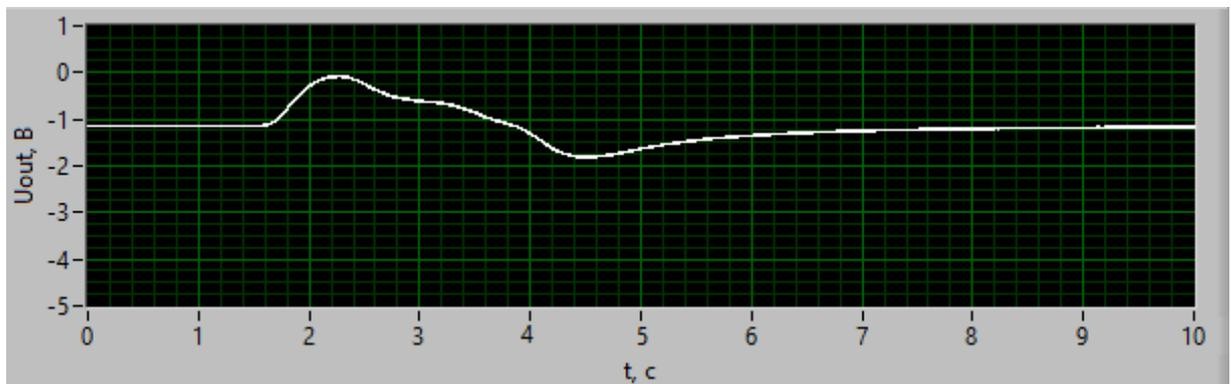
Рисунок 3.2 – Сигнал низкочастотной помехи на выходе ПСН ( $R_{INS}=1000$  ГОм,  $C_I=1$  нФ,  $U_{REF}=100$  В,  $R_I=100$  МОм,  $R_2=100$  кОм,  $R_3=1010$  Ом,  $R_{EQ}=10$  ГОм), вызванный оператором
