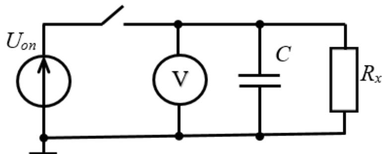
Рисунок 1.9 – Схема измерения сопротивления методом заряда-разряда конденсатора
