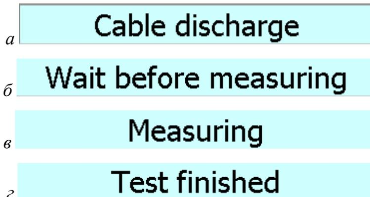
Рисунок 5.7 – Режимы работы прибора: разряд кабеля (*a*), ожидание перед измерением (*б*), измерение (*в*), завершение контроля (*z*)
