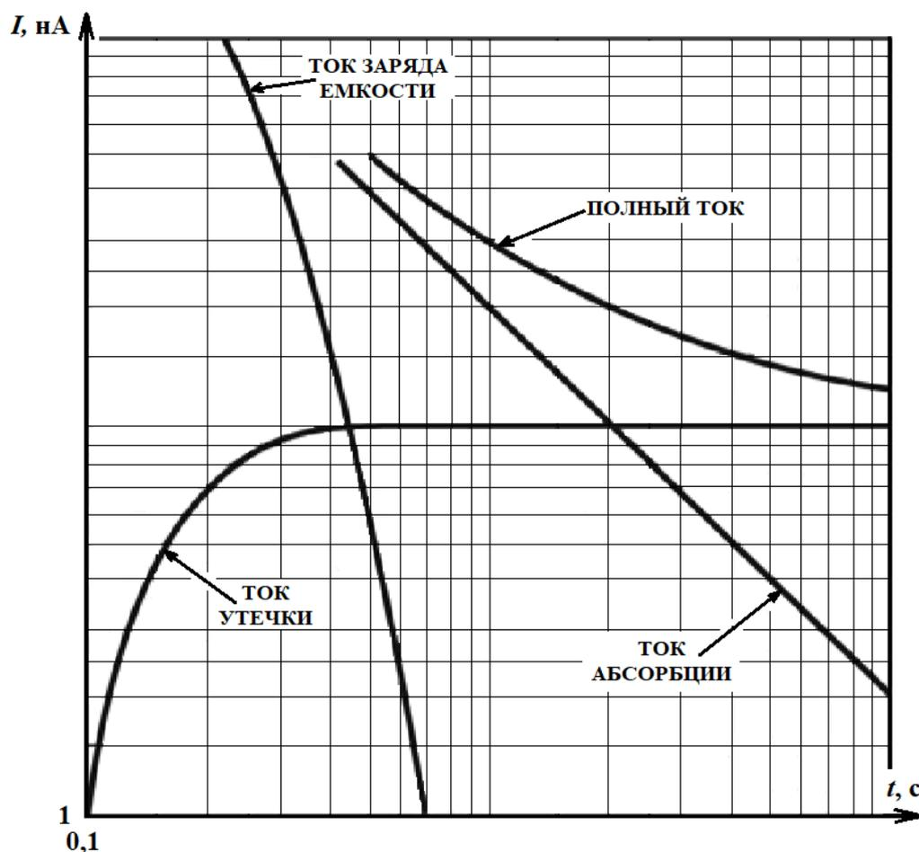
Рисунок 1.4 – Временные диаграммы составляющих полного тока при измерении сопротивления изоляции кабеля
