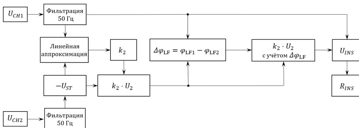
Рисунок 4.3 – Алгоритм адаптивной обработки сигнала с использованием линейной аппроксимации для определения коэффициента  $k_2$
