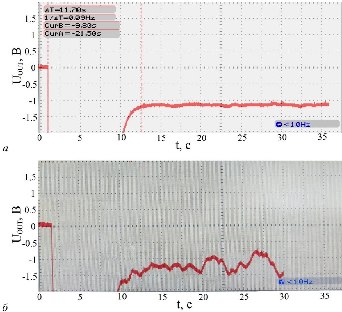
Рисунок 2.18 – Осциллограммы переходного процесса выходного напряжения ПСН ( $U_{REF}=100\text{ В}$ ,  $R_{EQ}=10\text{ ГОм}$ ,  $R_{INS}=1\text{ ТОм}$ ,  $C_{INS}=10\text{ нФ}$ ,  $CI=1\text{ нФ}$ ): с Т-образной обратной связью ( $R1=100\text{ МОм}$ ,  $R2=100\text{ кОм}$ ,  $R3=1010\text{ Ом}$ ) (а) и с классической обратной связью (б)
