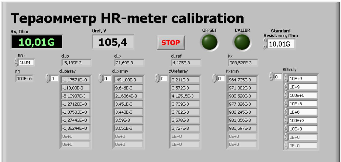
Рисунок 5.4 – Лицевая панель программы «рабочей» настройки тераомметра Т-01
