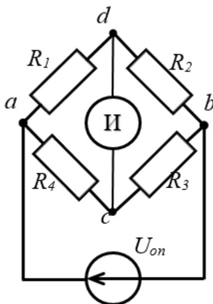
Рисунок 1.7 – Схема одинарного моста постоянного тока
