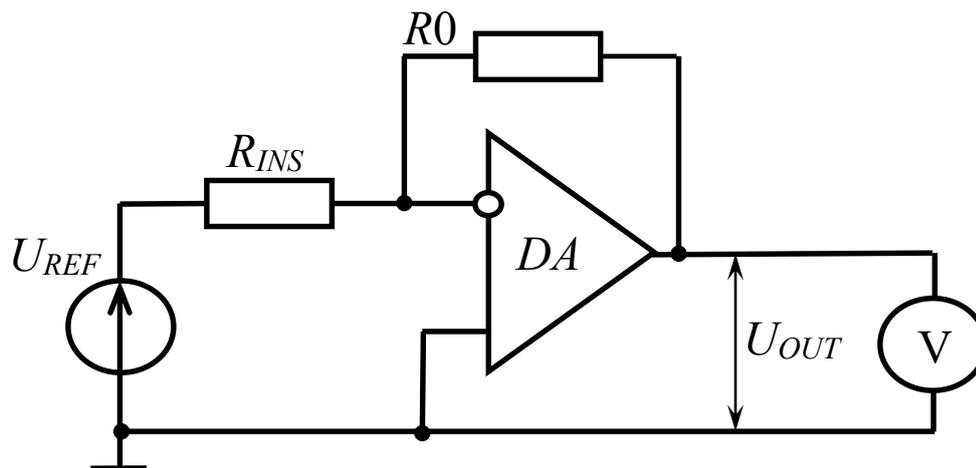
$DA$  – операционный усилитель;  $U_{REF}$  – источник опорного напряжения;  $R_{INS}$  – сопротивление изоляции;  $R_0$  – образцовое сопротивление
