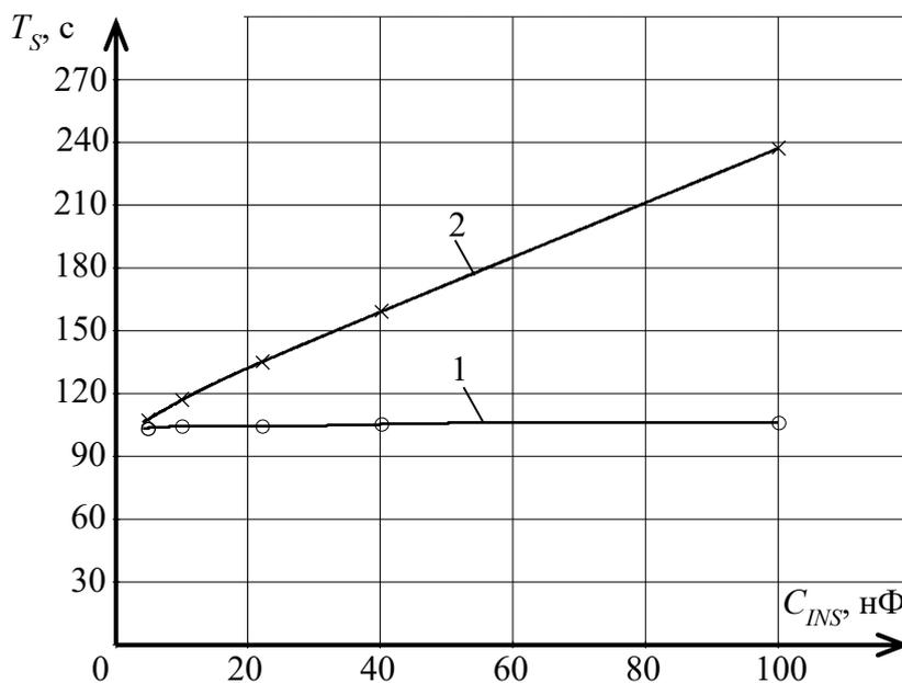
1 – экспериментальная зависимость ПСН с Т-образной обратной связью ( $R1=10$  МОм,  $R2=100$  кОм,  $R3=1010$  Ом,  $R_{EQ}=1$  ГОм); 2 – экспериментальная зависимость ПСН с классической обратной связью  $R_{EQ}=1$  ГОм
