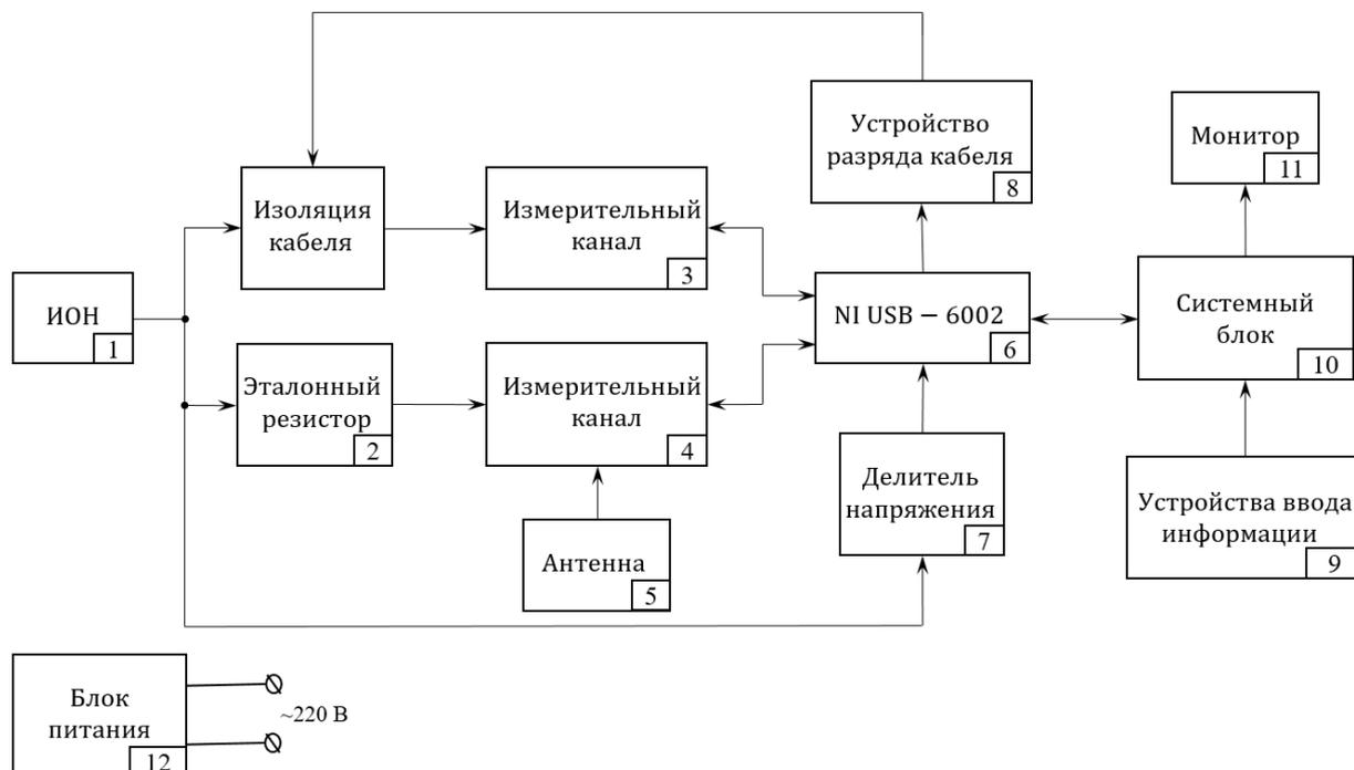
1 – ИОН; 2 – эталонный резистор  $R_{ST}$ ; 3 – первый ИК; 4 – второй ИК; 5 – антенна; 6 – устройство сбора данных NI USB-6002; 7 – делитель напряжения; 8 – устройство разряда кабеля; 9 – устройства ввода информации; 10 – системный блок; 11 – монитор; 12 – блок питания
