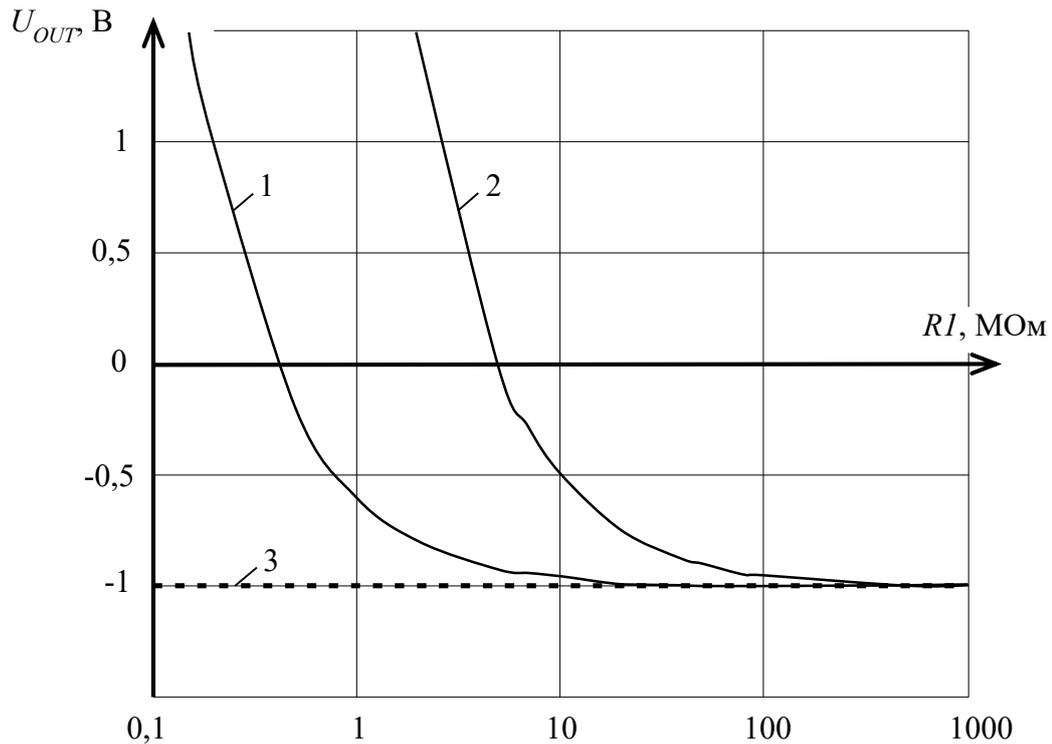
1 – теоретическая зависимость  $U_{OUT(T)}$  с входным ОУ ADA4530-1; 2 – теоретическая зависимость  $U_{OUT(T)}$  с входным ОУ AD549L; 3 – теоретическая зависимость, при идеальном ОУ  $U_{OUT(ID)}$
