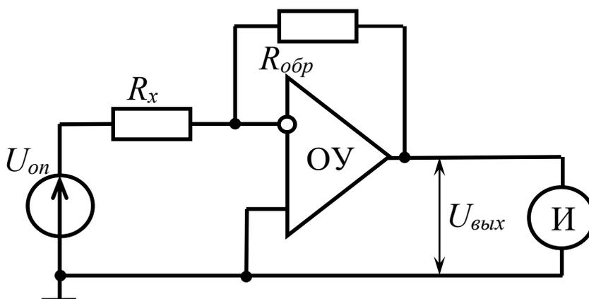
Рисунок 1.6 – Схема преобразования сопротивления в напряжение
