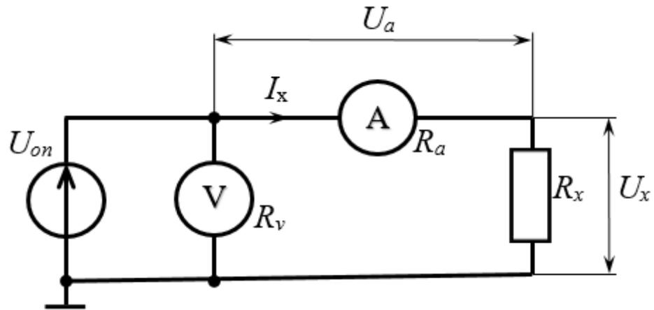
Рисунок 1.8 – Схема измерения больших сопротивления методом вольтметра-амперметра
