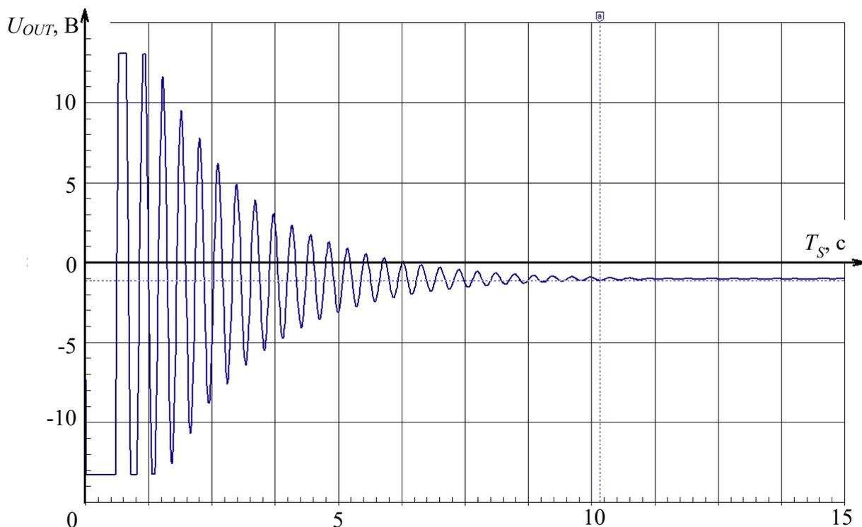
Рисунок 2.10 – Переходный процесс выходного напряжения ПСН с Т-образной обратной связью ( $R1=1$  МОм,  $R2=100$  кОм,  $R3=1010$  Ом,  $R_{EQ}=0,1$  ГОм,  $R_{INS}=10$  ГОм,  $C_{INS}=100$  нФ,  $C1=1$  нФ,  $U_{REF}=100$  В)
