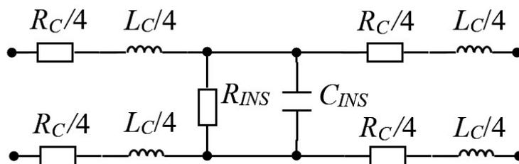
Рисунок 1.2 – Эквивалентная схема замещения реального двухжильного кабеля
