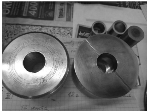
Рисунок 2.1 – Пресс-форма для изготовления образцов тороидальной формы
