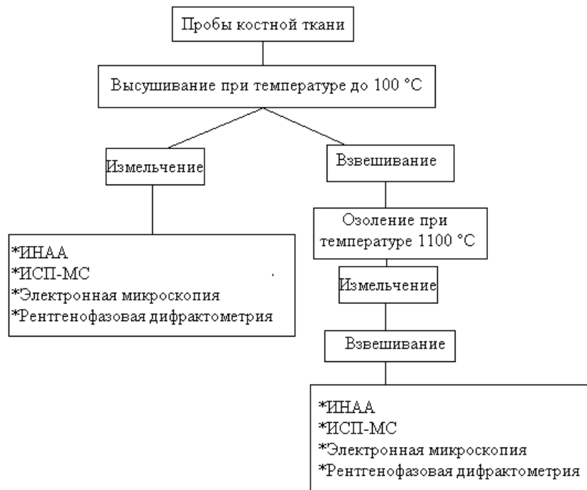
Рисунок 4.2 – Схема проведения эксперимента по изучению поведения элементов при высокотемпературном озолении костной ткани.
