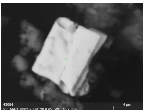
Рисунок 7.23 – Общий вид оловосодержащей минеральной фазы в ЗООЧ г. Екатеринбурга и энерго-дисперсионный спектр в точке исследования
