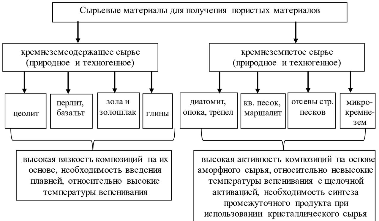
*Рисунок 1.1 – Особенности использования кремнеземсодержащих сырьевых материалов для получения пористого стеклокомпозита*
