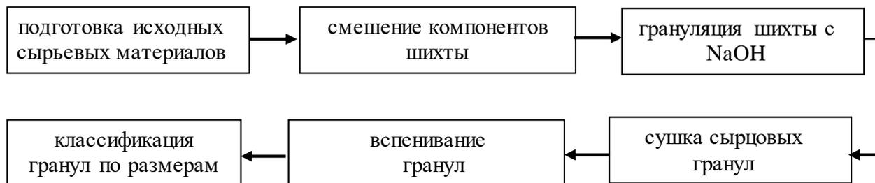
*Рисунок 1.2 – Схема одностадийной технологии гранулированного пористого материала*
