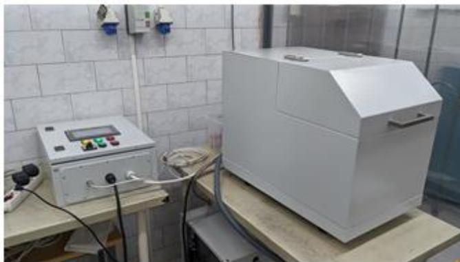
Рисунок 2.2 – Фотография планетарной шаровой мельницы АГО-2
