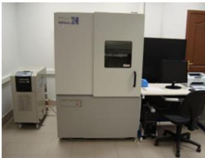
Рисунок 2.6 – Внешний вид дифрактометра Shimadzu XRD-7000S
