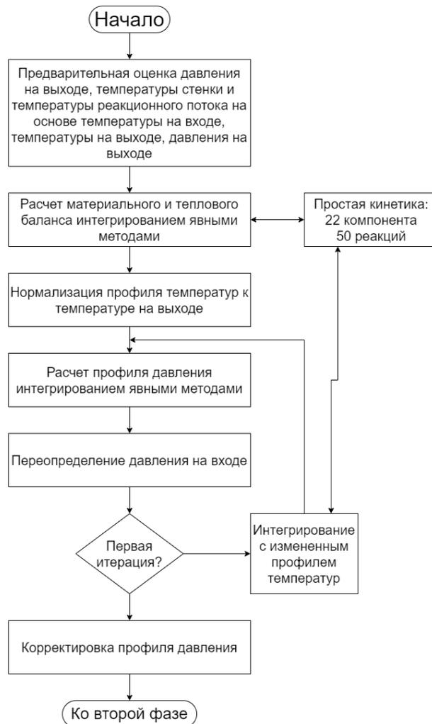
Рисунок 16 – Блок-схема расчета в первой стадии
