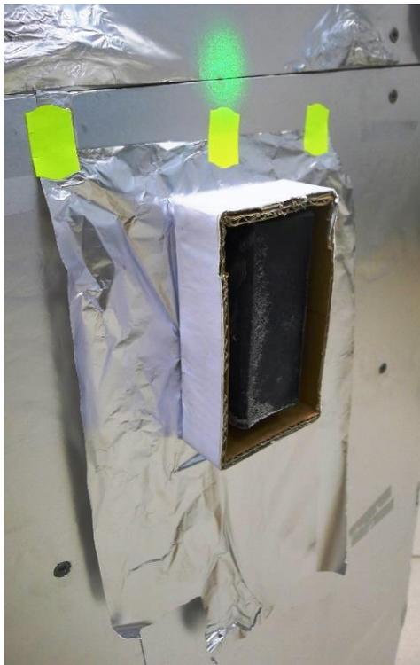
Рисунок 3.8 – Коробка с имитатором ТНТ на мишени
