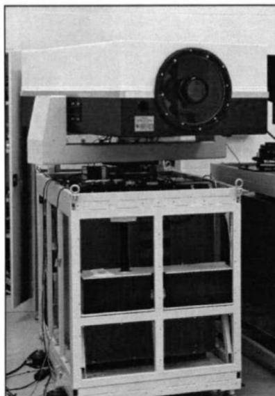
Рисунок 1– Общий вид лазерного дистанционный детектора ВВ
