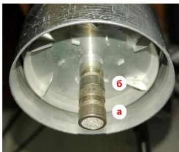
Рисунок 4.4 – Последовательное размещение концентраторов
