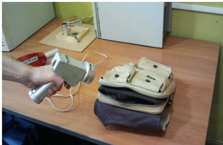
Рисунок 3.2 – Процесс отбора пробы воздуха пробоотборным устройством
