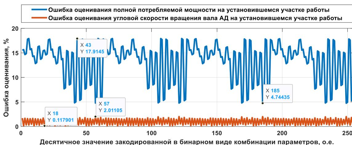
**Рисунок 3.4.2.** Результаты полного факторного эксперимента при исследовании ошибки оценивания угловой скорости вращения АД (красная) и полной потребляемой мощности (синяя) при изменении параметров
