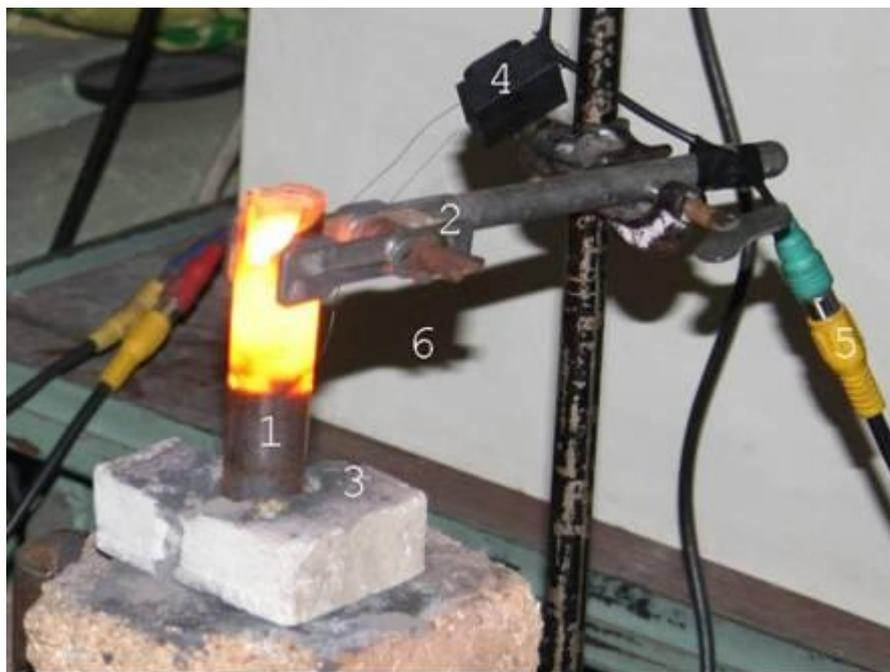
1 – кварцевая колба с реагентами; 2 – штатив; 3 – основание; 4 – зажим термопары; 5 – провода термопар; 6 – персональный компьютер IBM-PC с аналого-цифровым преобразователем ЛА-1,5РСІ
