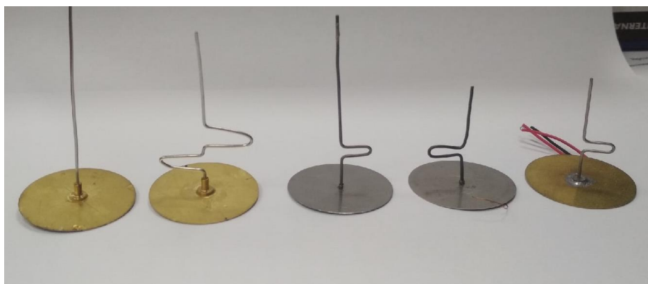
Рисунок 16. Различные варианты датчиков и волноводов, используемые в работе
