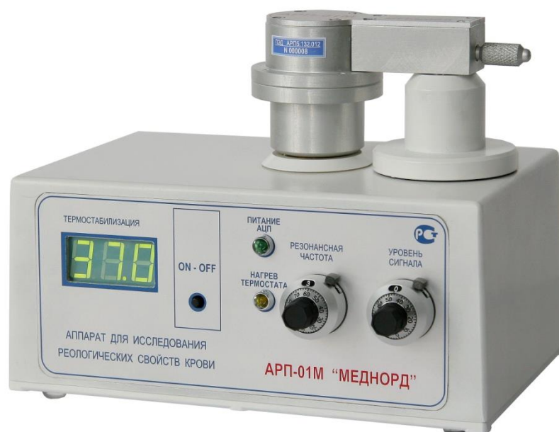
Рисунок 10. АРП-01М «Меднорд» – технология низкочастотной пьезотромбоэластографии [93]
