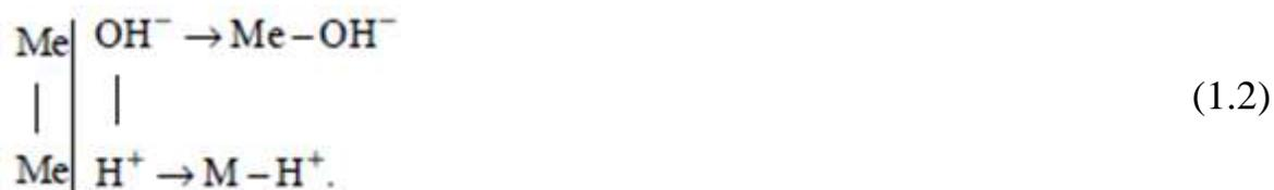
Образование связей по схеме (1.2) было обосновано с помощью метода ИК-спектроскопии поверхностных соединений, формирующихся при адсорбции паров воды на высокодисперсном алюминии. Дальнейшие изменения в системе определяются физико-химическими свойствами исходных веществ. Главными показателями при этом являются растворимость в воде, склонность к ионизации, комплексообразованию и гидролизу.
