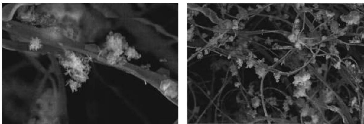
Рисунок 5.6 – СЭМ-изображения полимерных микроволокон ацетата целлюлозы, модифицированных НК-Zn
