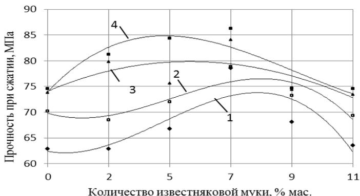
Рис. 3. Зависимость прочности цементного камня от количества известняковой муки и продолжительности твердения:
