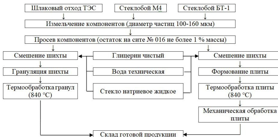
Рисунок 12 – Технологическая схема производства пеностеклокристаллических изделий
