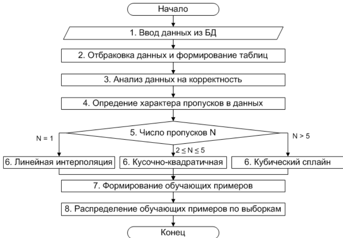
Рисунок 1 – Укрупнённая схема адаптивного алгоритма предварительной подготовки данных при формировании обучающей и тестовой выборок для решения задачи прогноза дебитов
