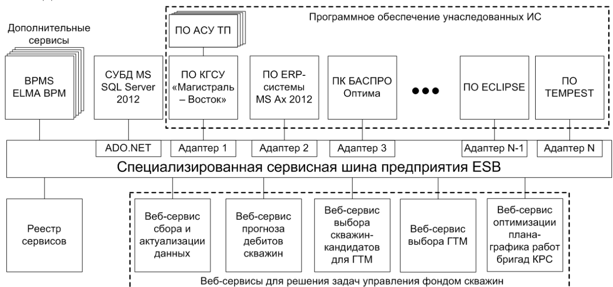
Рисунок 6 – Архитектура ПО единого информационного пространства АО «Газпром добыча Томск»
