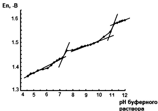
Рисунок 2 - Зависимость  $E_p$  галонала от pH фонового электролита.
