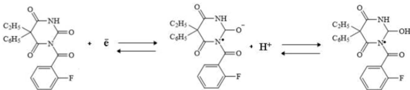
Рисунок 3 - Возможный механизм реакции восстановления галонала на поверхности СУЭ, фоновый электролит - 0,1М Na<sub>2</sub>SO<sub>3</sub>, E<sub>нак</sub> - -0,8В, t<sub>нак</sub> - 30 с
