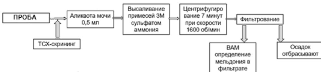
Рисунок 9 - Алгоритм вольтамперометрического определения мелдония
