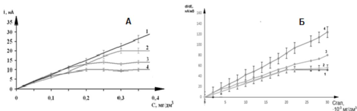
Рисунок 8 - Градуировочные зависимости аналитических сигналов мелидония (А) и галонала (Б) от вида модификатора: А) 1 - АДТ без заместителя; 2 – АДТ с  $\text{NH}_2$ -заместителем; 3 – АДТ с  $\text{COOH}$ -заместителем; 4 – ЗГЭ без модифицирования АДТ. Б) 1 – СУЭ без модифицирования АДТ; 2 – АДТ с  $\text{NO}_2$ -заместителем; 3 – АДТ с  $\text{NH}_2$ -заместителем; 4 – АДТ с  $\text{COOH}$ -заместителем.
