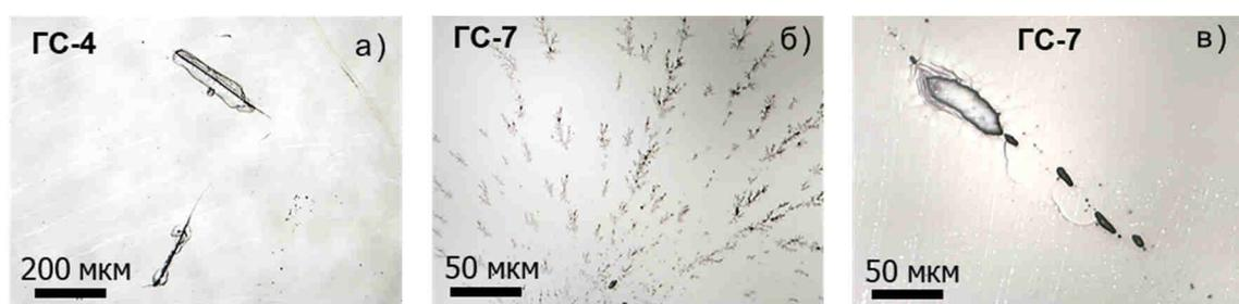
Рис. 11. Морфология разрушений в образцах ГС-4 (а) и ГС-7 (б, в) после облучения СЭП при  $H = 0,6$  Дж/см<sup>2</sup>.
