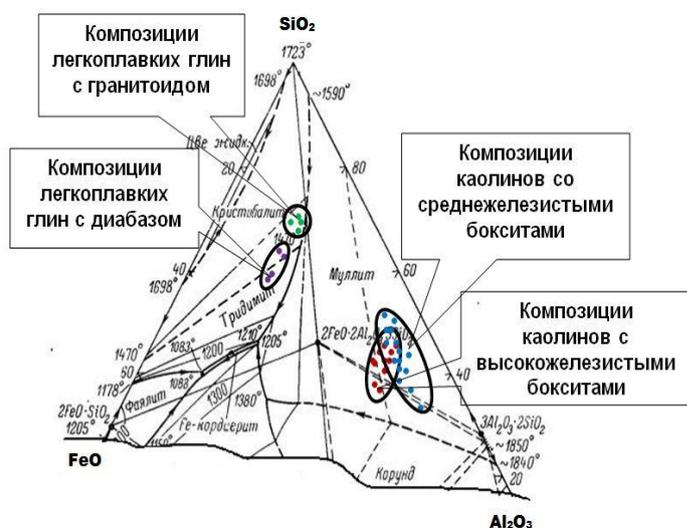
**Рисунок 3 – Области составов исследуемых композиций легкоплавких и огнеупорных глин с добавками в системе  $FeO - Al_2O_3 - SiO_2$**
