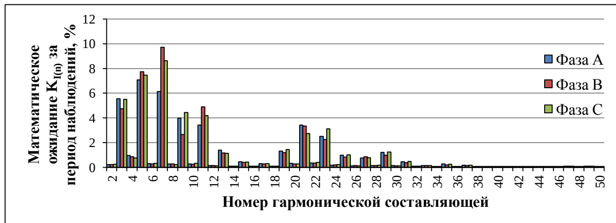
Рис. 9. Измеренный гармонический состав токов в ВЛ
